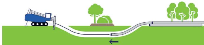
Figure 20 : Schéma de pose sans tranchée en sous-œuvre
