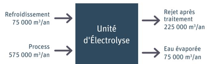
Figure 14 : Besoins en eau industrielle et rejets pour la production d'hydrogène
