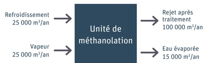
Figure 15 : Besoins en eau industrielle et rejets pour la production de e-méthanol
